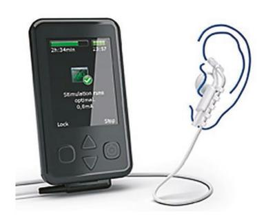
Ohrelektrode und einer Stimulationseinheit in der Größe eines Mobiltelefons. Der betroffene Patient bestimmt selbst, in welcher Intensität und in welchem Intervall der Vagusnerv im Ohr elektisch stimuliert wird.
