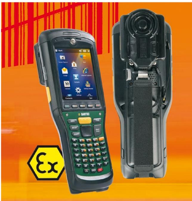
Das Aufsteckmodul für Handscanner der Motorola® MC95-Serie ermöglicht das berührungslose identifizieren von Gegenständen, so etwa das Erfassen von Barcodes bei Paketdiensten.
