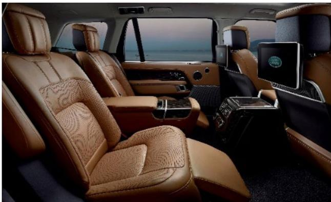
Die Herausforderung war die Integration eines elektrischen Antriebes und eines selbsthemmenden Getriebes für das Aus- und Einklappen der Armlehne. Hierbei musste besonderes Augenmerk auf das hohe Gewicht der MAL gelegt werden, welches bei der Auslegung zur Crashesicherheit berücksichtigt werden musste. Neben einem doppeltem Ablagefachdeckel mit großem Ablagefach sollte außerdem eine elektrisch höhenverstellbare Kopfstütze und ein Doppelcupholder integriert werden.
