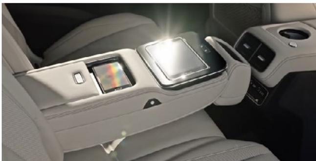
Besonderes Augenmerk musste hierbei auf die Auslegung und Integration eines Verriegelungskonzeptes, welches die nötigen erhöhten Crashanforderungen in der Fondsitzeihe eines SUV's erfüllt, gelegt werden. Neben einem Ablagefach mit USB-Schnittstelle und einem Handyfach in der Kopfstütze, verfügt die Armlehne über ein WMI-Modul, welches das induktive Laden von Mobiltelefonen ermöglicht. Das Command-Center mit
